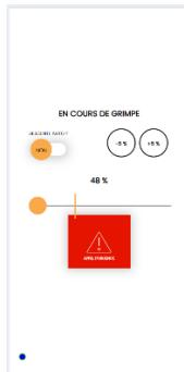
Fenêtre de commande pendant la grimpe, ici les fonctionnalités sont les mêmes qu'avec la télécommande. Pour engager la descente il vous suffit d'activer « descente automatique ».
